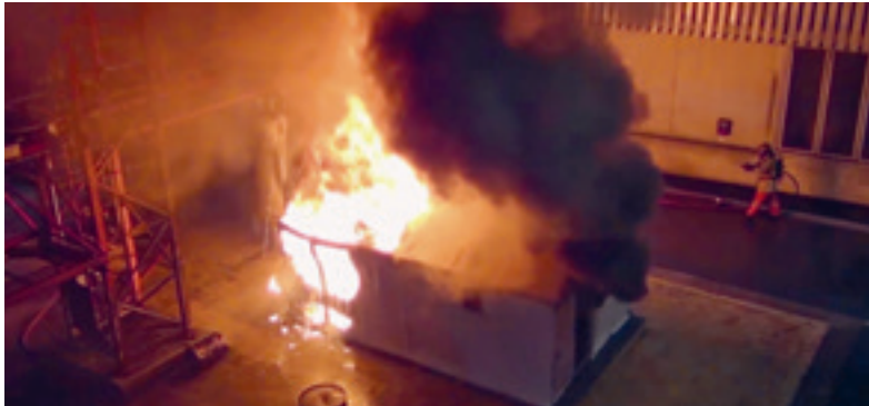
Obwohl offiziell als brandfest eingestuft, brannten die BetterShelter-Ikea-Häuschen bei einem Test in 90 resp. 30 Sekunden weg.
